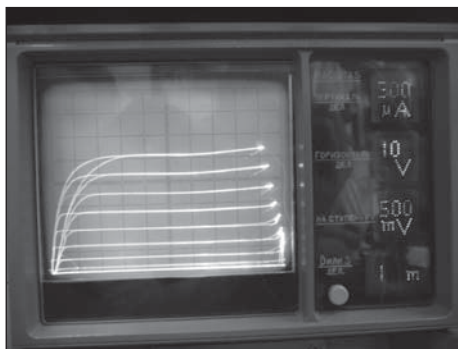
Рис. 4. Выходные характеристики HV nМОП- и pМОП-транзисторов
